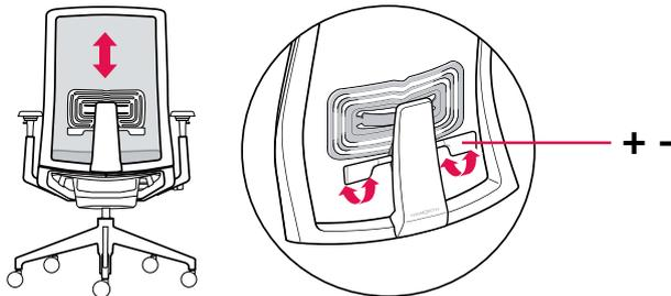
Schieben Sie die Lumbalstütze mit beiden Händen hoch oder herunter, um sie auf Ihre Körpergröße einzustellen. Drehen Sie die Taste (Pfeil), um eine optimale Unterstützung rechts und/oder links zu erreichen. (Eine asymmetrische Unterstützung ist einer der wichtigsten Vorteile vom Very Task Stuhl.)
