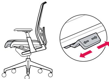
Für verschieden große Personen kann durch das Einstellen der Sitztiefe (verschieben der Sitzfläche nach hinten oder nach vorne) eine bessere Unterstützung der Oberschenkel erreicht werden. Zum Lösen drücken Sie die Taste (Pfeil) nach oben und schieben den Sitz zur gewünschten Position.
