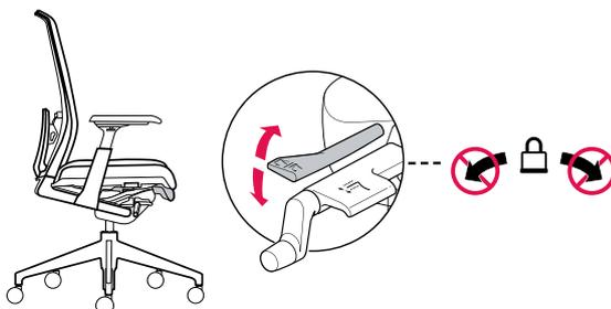
Durch das Neigen der Sitzfläche optimieren Sie Ihre Beckenposition und reduzieren damit die statische Belastung auf Ihre Wirbelsäule. Der sogenannte offene Sitzwinkel fördert die Durchblutung und erleichtert die Atmung. Zur Einstellung der Neigung drehen Sie die Taste (Pfeil) in die obere Position. Die Sitzneigeverstellung schaltet sich automatisch zu. Um wieder auf die neutrale Stellung zu kommen drehen Sie die Taste zurück und belasten Sie dabei den hinteren Bereich der Sitzfläche.
