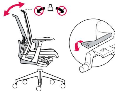
Ihr Stuhl besitzt eine Synchronmechanik, die das bandscheibenschonende, dynamische Sitzen unterstützt. Stellen Sie den Gegendruck der Rückenlehne durch Drehung der Kurbel auf Ihr Individualgewicht ein. Durch Einrastung der Taste in die Mittelposition passt sich der Öffnungswinkel der Rückenlehne der Körperhaltung des Nutzers frei an. In der untersten Tastenposition können Sie den Öffnungswinkel der Rückenlehne in der Grundposition feststellen.
